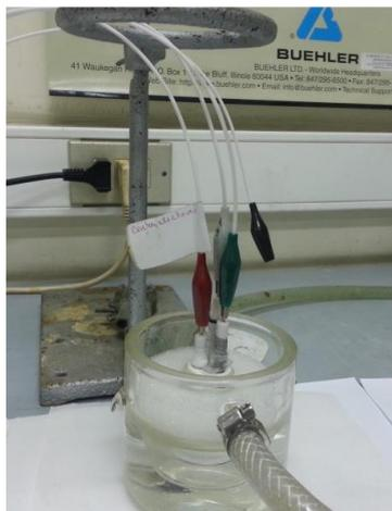
**Figura 1.** Celda electroquímica de 10 mL con chaqueta termostatazada.
