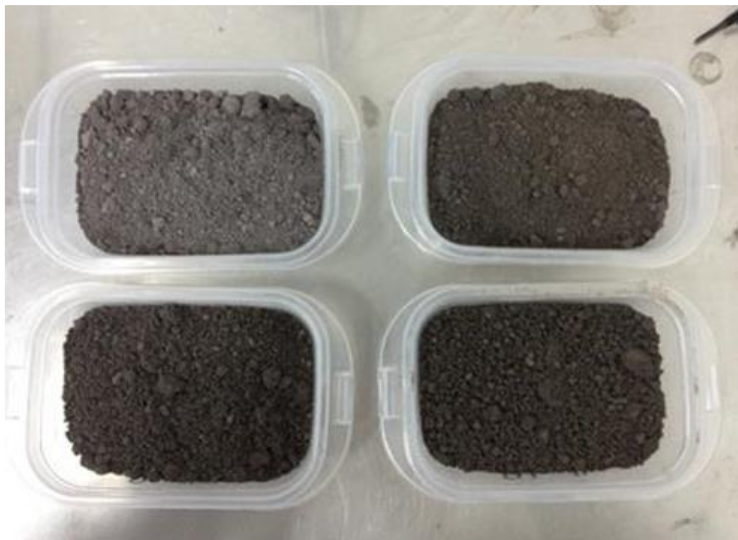
Figura 3. Reposo del mineral con control horario de humedad (pérdida de peso)
